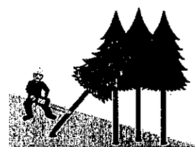
(図5) かかっている木の元玉切り
